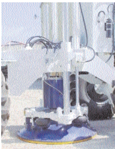
Fig. 2. Particolare della massa vibrante e della piastra della sorgente sismica vibratoria MINIVIB.
