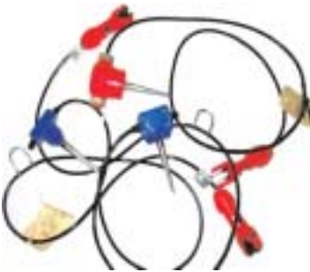
Fig. 3. Geofoni: 10 Hz verticali e orizzontali (colore blu) e 40 Hz verticali (colore rosso).
