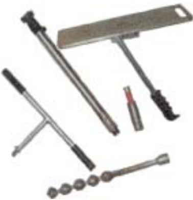
Fig. 1. Componenti della sorgente impulsiva MINIBANG.
