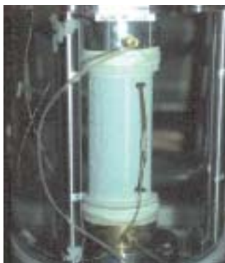
Fig. 7. Trasduttore LDT per la misura delle deformazioni assiali.
