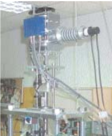
Fig. 3. Sistema di applicazione dei carichi assiali.
