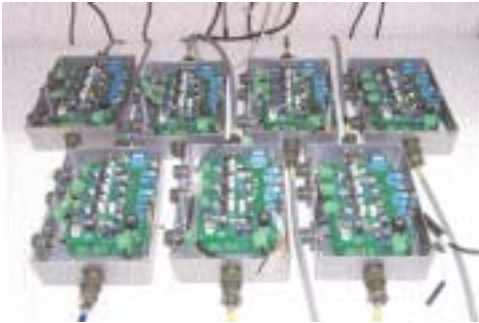
Fig. 8. Moduli di acquisizione a 3 canali. Se ne possono collegare fino a 4 in serie su ognuna delle 4 linee.
