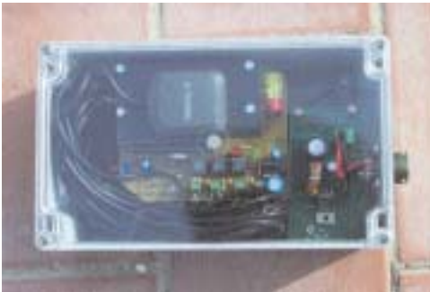
Fig. 9. Modulo GPS per la sincronizzazione assoluta dei dati acquisiti.
