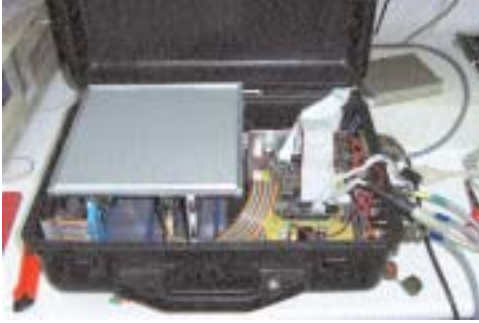
Fig. 7. Modulo centrale: gestisce il sincronismo dei moduli periferici di acquisizione e salva i dati su hard disk.
