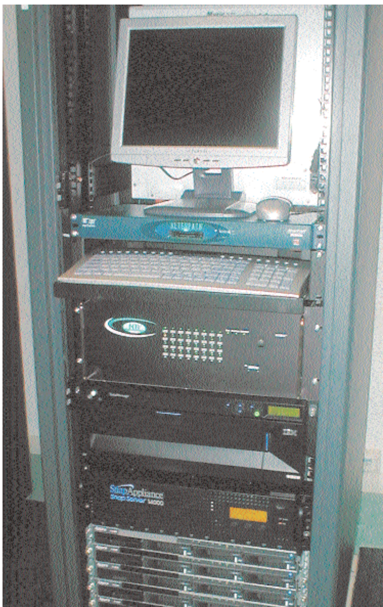
Fig. 3. Alter Path ACS, Switch KVM, unità di backup IBM e Snap Server.
