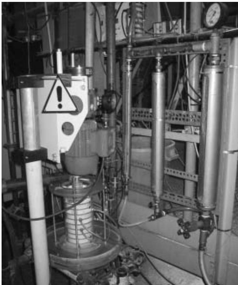
Fig. 7. Foto dell'impianto di fluidizzazione equipaggiato con l'agitatore meccanico.
