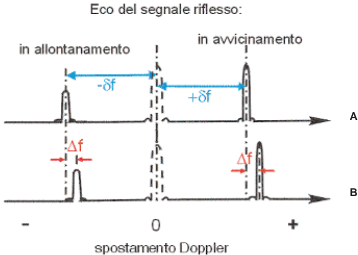
Fig. 2. Effetto Doppler dovuto a propagazione delle onde e correnti superficiali. A. Spostamento Doppler del segnale retroriflesso indotto dalla propagazione in avvicinamento (segno +) o in allontanamento (segno -) dal sito radar delle onde di gravità superficiali, dato da \pm \delta f = \pm 2v/\lambda con v = velocità radiale delle onde di gravità superficiali rispetto alla stazione ricetrasmittente. B. Ulteriore spostamento Doppler \Delta f dovuto alla presenza di una corrente superficiale in avvicinamento alla stazione ricetrasmittente. Il picco centrale corrisponde al segnale trasmesso.
