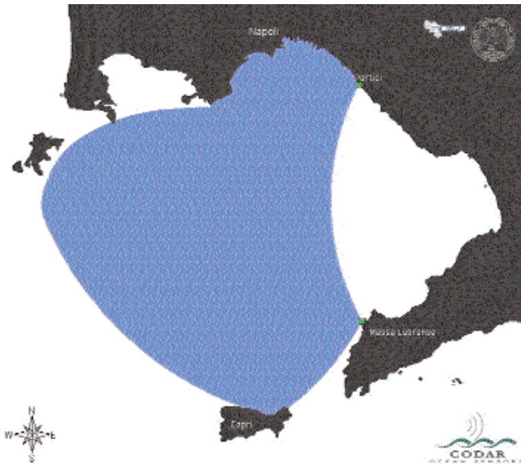
Fig. 3. Copertura del sistema installato nel Golfo di Napoli. Si noti che il Golfo di Pozzuoli è schermato dalla collina di Posillipo.
