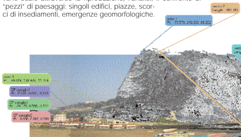
Fig. 11. Area ex industriale Italsider, Bagnoli, Napoli. Il costone di Coroglio: montaggio tra nuvole di punti e foto.
