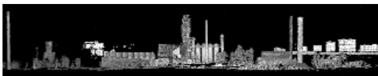
Fig. 12. Area ex industriale Italsider, Bagnoli, Napoli. Manufatti di archeologia industriale: nuvola di punti.
