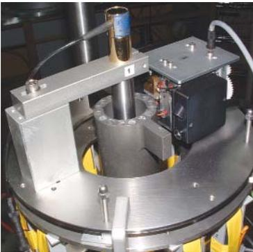
**Fig. 7.** Triangolatori laser per la misura delle rotazioni delle testa del provino.
