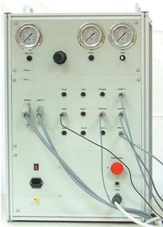
stema di alimentazione consente di evitare gli errori di misura dello smorzamento derivanti dalla generazione di una forza elettromotrice indotta nel motore elettromagnetico.
