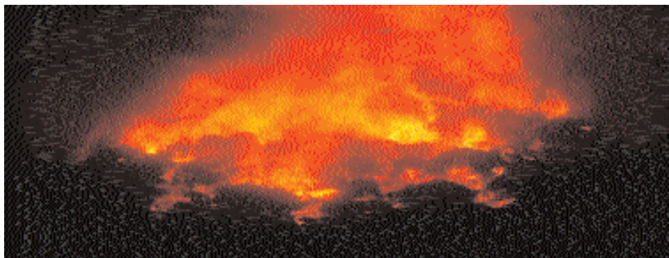
Immagine di letto di rifiuti durante la combustione (Waste Incineration Centre, University of Sheffield).
