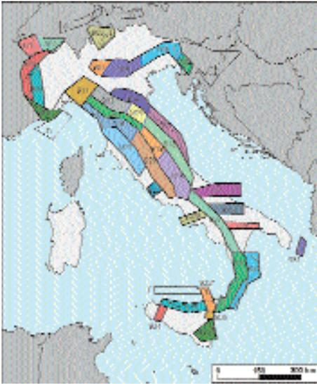
**Fig. 6.2.** Zonazione sismogenetica ZS9. I limiti di colore blu separano le zone con analogo significato cinematico, che differiscono principalmente per le caratteristiche di sismicità. Le ZS con bordo a tratteggio, identificate da una lettera, non sono state utilizzate nella valutazione della pericolosità.
